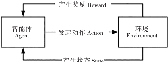
图 3 强化学习架构图 Fig.3 Framework of reinforcement learning
